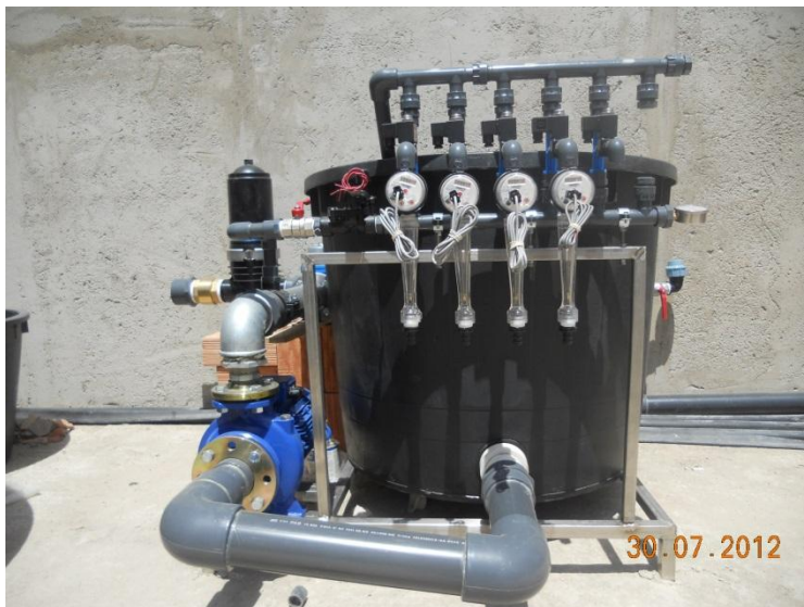
Banco di Fertirrigazione con «miscelazione totale»
